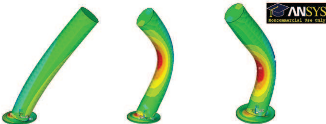
Figure III-26 : Déformée de la structure à différentes fréquences. De gauche à droite : 2 kHz, 8,5 kHz et 20 kHz.
