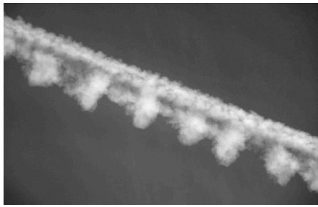
FIGURE II-3 – Régime de dissipation. Le sillage primaire est regroupé en paquets, contrairement au second sillage.
