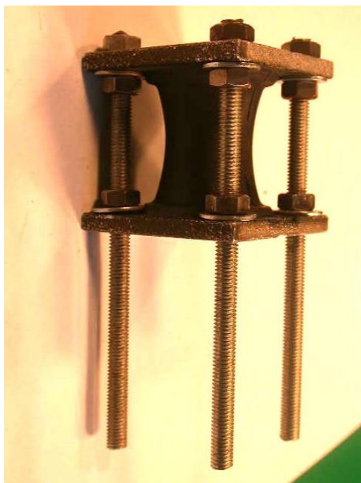
Figure 10. Montage de traction de l'éprouvette pour observation sous MEB.
