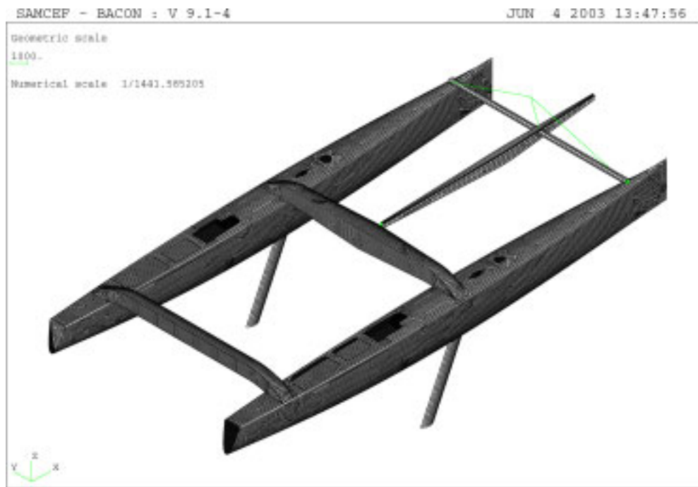
Figure 5. Maillage éléments finis coques du Code B1 (plan Ollier).
