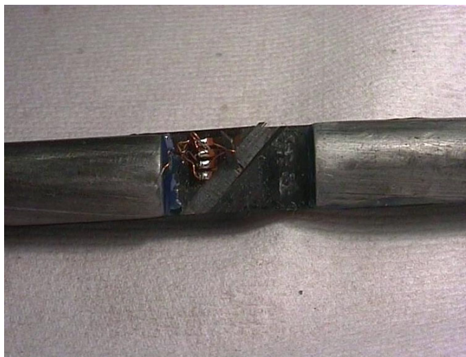
Figure 20. Faciès de rupture des éprouvettes (\pm 45)_{2s}
