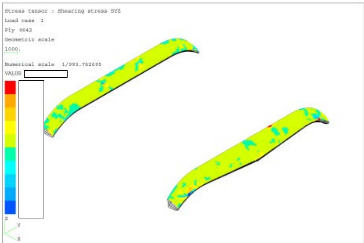
Figure 8. Distribution de la contrainte \sigma_{13} dans le Nomex de carénage
