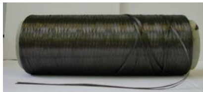
Figure PE-1 : Bobine de fibres de carbone de diamètre 10 \mu m.
