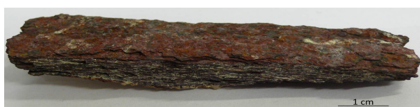
Figure 1.10 : Échantillon de couches de produits de corrosion provenant du Palais des Papes en Avignon.
