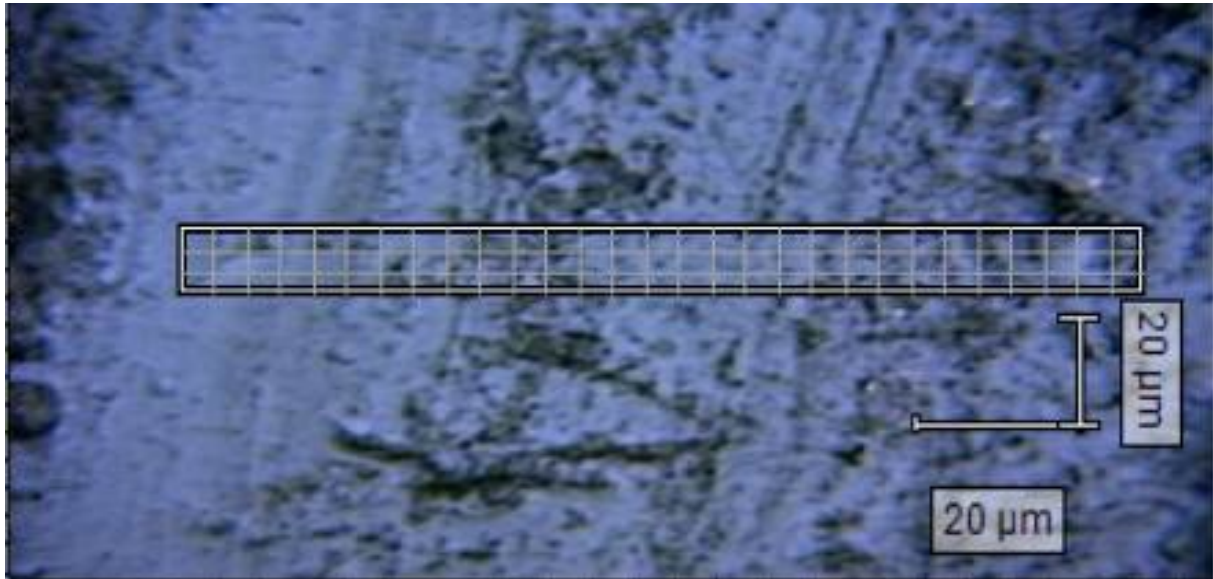
Figure B.3 : Cartographie Raman sur l'échantillon de corrosion accélérée.
