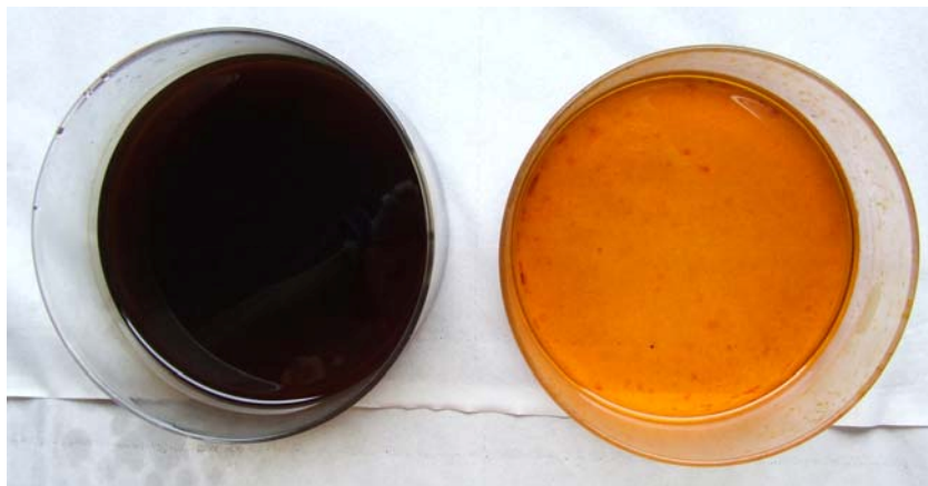
Fig. .3 Comparaison de la couleur des deux huiles après 15 jours à 120°C (leurs couleurs initiales sont similaires) a: Huile minérale, b: Huile RS50
