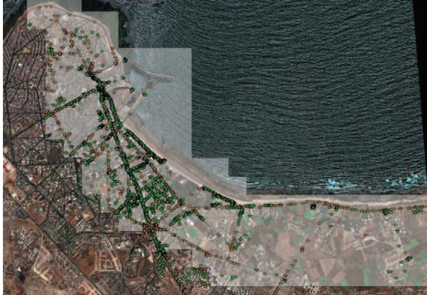
Figure 85. Géoréférencement des véhicules en stationnement (vert) et en déplacement (orange) présents sur l'image QuickBird du 15 juillet 2009 à 11h34. Utilité pour le calcul des densités de débris potentiels par tronçon de rue (Leone et al., 2012).
