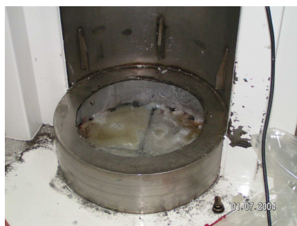
FIGURE 2.3.4: Coffre neutrons après modifications. Les modifications sont le retrait de la paraffine et du cadmium qui étaient présents à l'intérieur du socle ci-dessus
