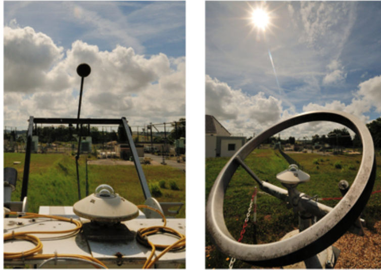
FIGURE 2.6 – Pyranomètre à boule et à bandeau circulaire du site EDF R&D des Renardières mesurant le flux diffusé horizontal Dir_h
