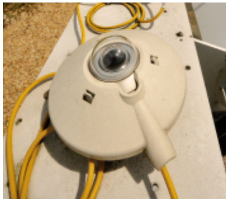
FIGURE 2.5 – Pyranomètre du site EDF R&D des Renardières mesurant le flux global horizontal G_{lo_h}
