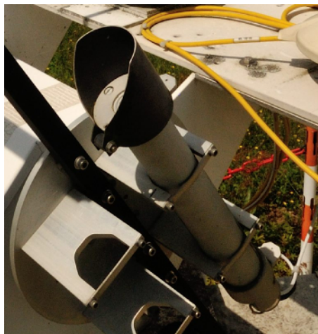
FIGURE 2.7 – Pyréliomètre du site EDF R&D des Renardières mesurant le flux direct normal Dir_n
