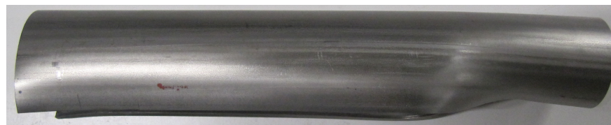
Fig. 2.51. Observation de côté du tube déformé ( L_f = 240\text{mm} )
