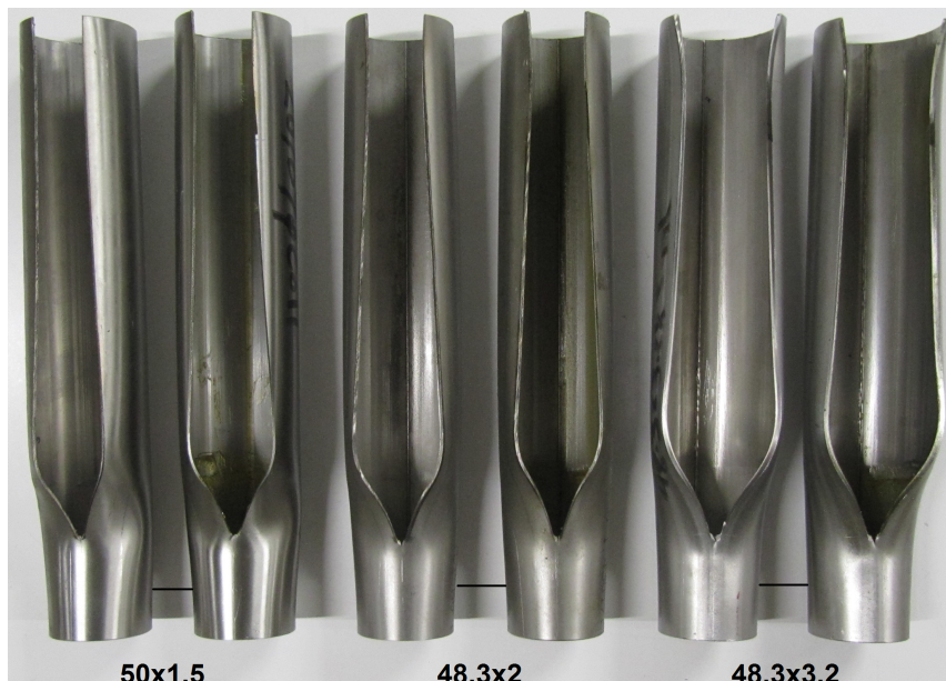
Fig. 2.48. Observation de face des tubes déformés ( L_f = 240\text{mm} ) pour différents D_o/T_o
