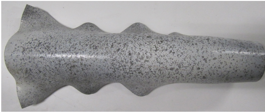
Fig. 2.46. Observation coté arrière du tube déformé ( L_f = 20\text{mm} )
