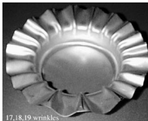
Fig. 1.6. Mode de flambage obtenu lors de la mise en forme des tôles métalliques [18]
