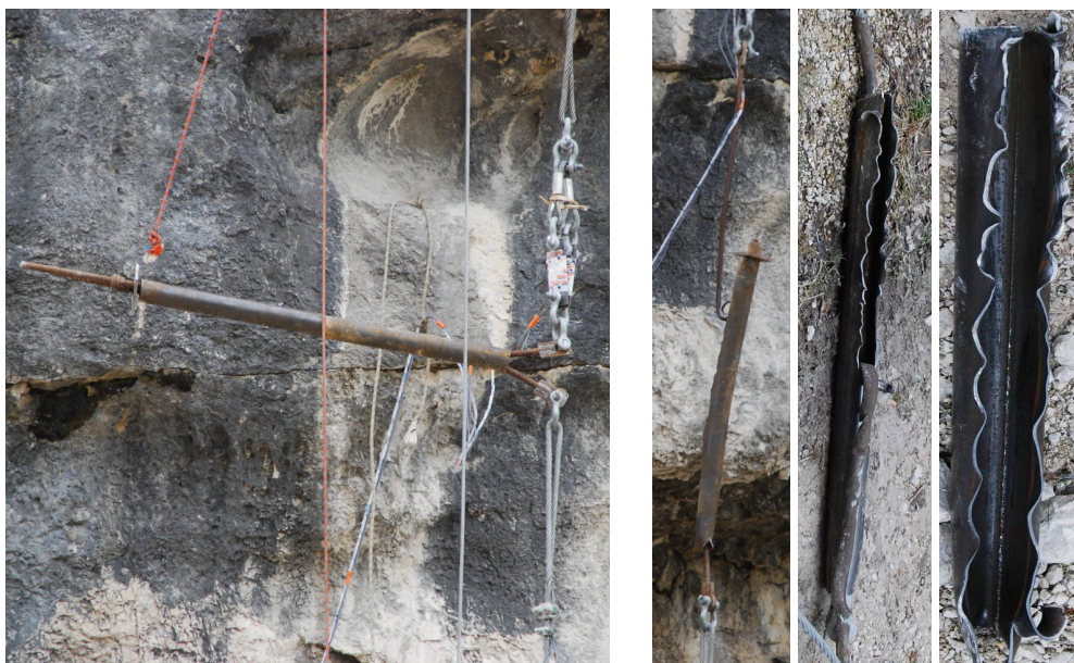
Fig. 1.3. Principe de déchirure du tube acier et résultats obtenus en dynamique
