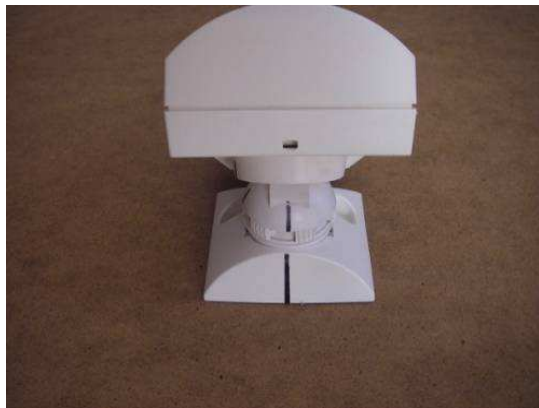
Illustration 10 : déplacements secondaires dans le plan vertical en haut et horizontal en bas avec le déplacement correspondant des marques.
