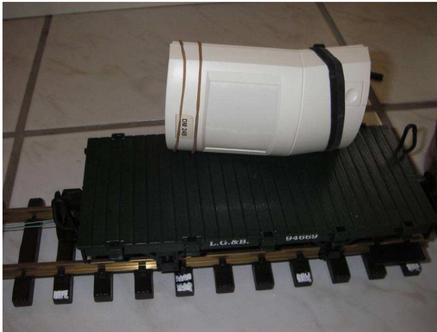
Illustration 12 : Capteur monté sur le wagon, en regard du rail distal, lentille libre, perpendiculaire au plateau
