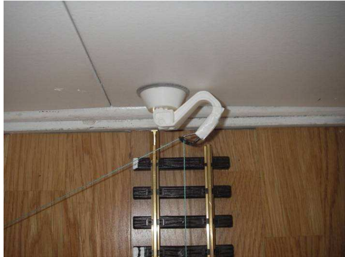
Illustration 14 : vue de haut de la réflexion du fil de traction du wagon sur l'anneau en carbure de silicium, la ventouse permet de fixer l'anneau à hauteur du tampon du wagon et au fil de se projeter en regard du milieu des deux rails.
