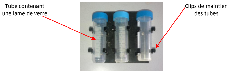
Figure 35 : Disposition des lames de verre dans des tubes accrochés à un support métallique pour leur maintien dans le fond de la bache.
