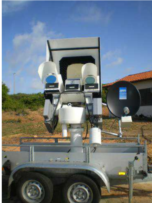
Figure 6 : Photographie du radiomètre ADMIRARI utilisé lors de la campagne CHUVA-GPM à Alcantara (MA) en 2010.
