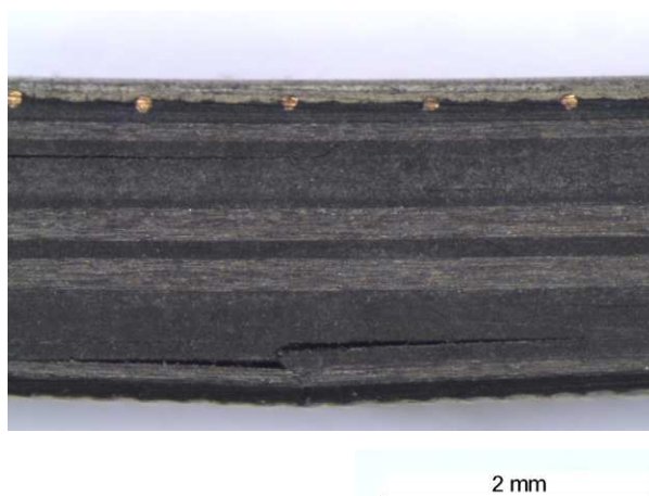
Figure 56 : Rupture en flexion
