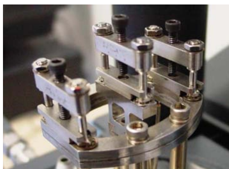
Figure 45 : Montage de flexion encastrée pour DMA
