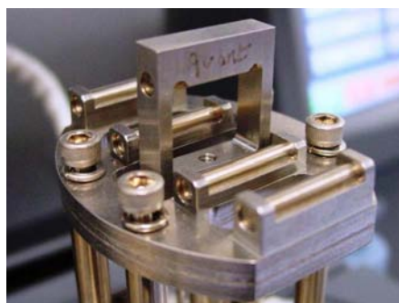
Figure 46 : Montage de flexion 3 points pour DMA
