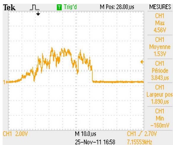
FIG 3. 26 - V_{det} obtenu à l'oscilloscope pour V_{set} = 0.78 \text{ V}
