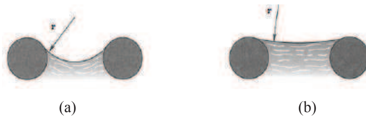
Figure 4.7. Formes du ménisque : (a) évaporateur, (b) condenseur
