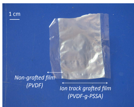
FIGURE 2.12 – Photo d'une membrane PVDF-g-PSSA radiogreffée dans les traces latentes après irradiation aux ions lourds rapides du GANIL
