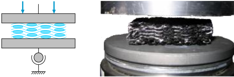
Figure 21 - Essai de compression transverse sur tissé épais
