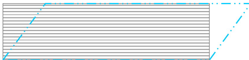
Figure 17 - Cisaillement transverse de la mèche
