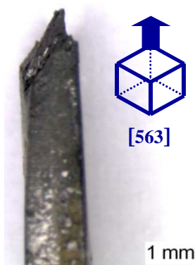
Figure I-128 : Léger gauchissement d'une éprouvette orientée [563] après rupture en fluage
