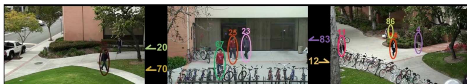
FIGURE 4.3 – Illustration du réseau de 3 caméras privé de Kuo et al. dans [Kuo et al. , 2010b]. L'apparence des personnes est relativement similaire dans chacune des caméras, et la topologie du réseau est linéaire, avec des caméras seulement reliées à leur voisine directe.
