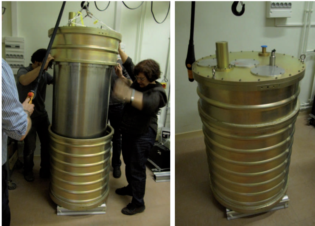
FIGURE I.28: Cryostat développé par l'Université de la Sapienza.
