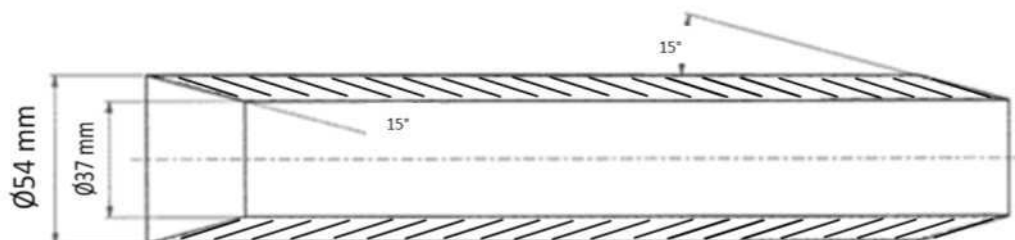
Figure 10 : Protection thermique "brute"
