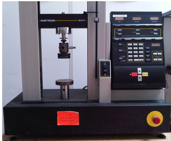
Figure 44 : Dispositif de compaction
