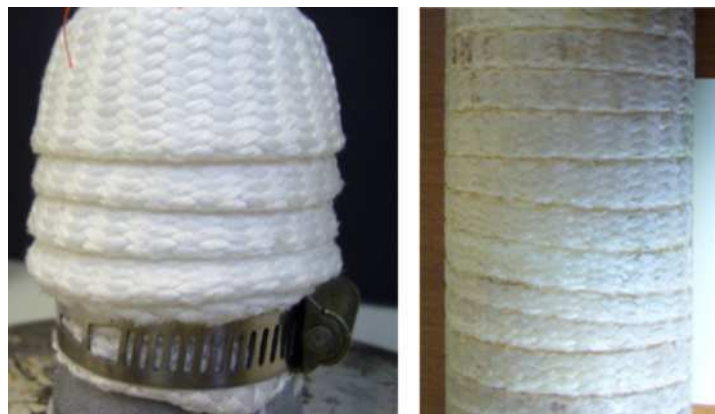
Figure 125 : Préforme de silice ( e_{\text{tresse}} = 0,8 mm) (Gauche : sèche - Droite : injectée)
