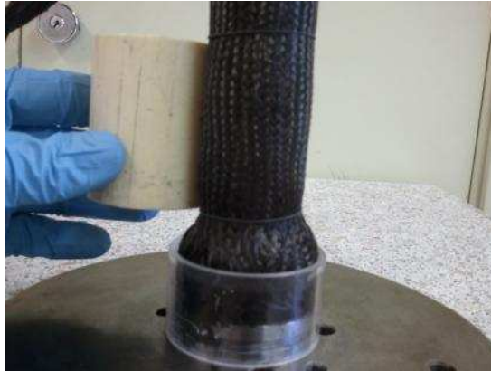
Figure 161 : Bague et gabarit en cours de préformage
