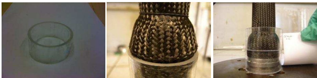
Figure 154 : Utilisation des bagues pour la maîtrise du diamètre extérieur
