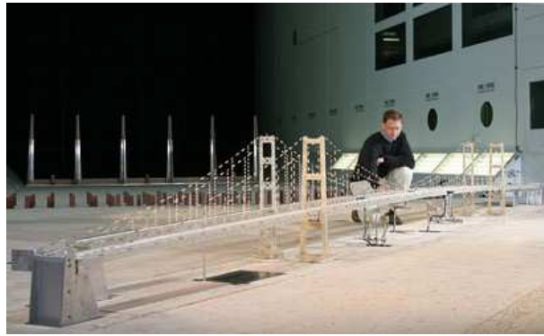
FIG. 1.2: Test en soufflerie d'un modèle du pont de Tacoma de 1940
