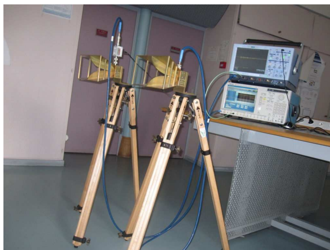
Figure 7-2 : Prototype du système de classification des types de cibles réalisé au laboratoire
