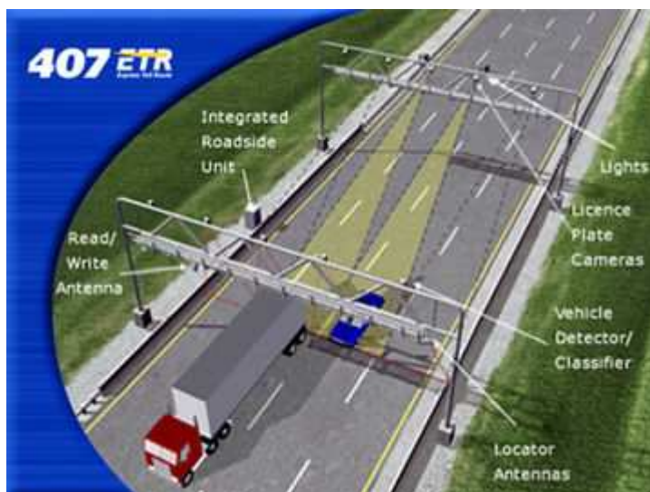
Figure 0 - 5 : Système de télépéage à Toronto [13]
