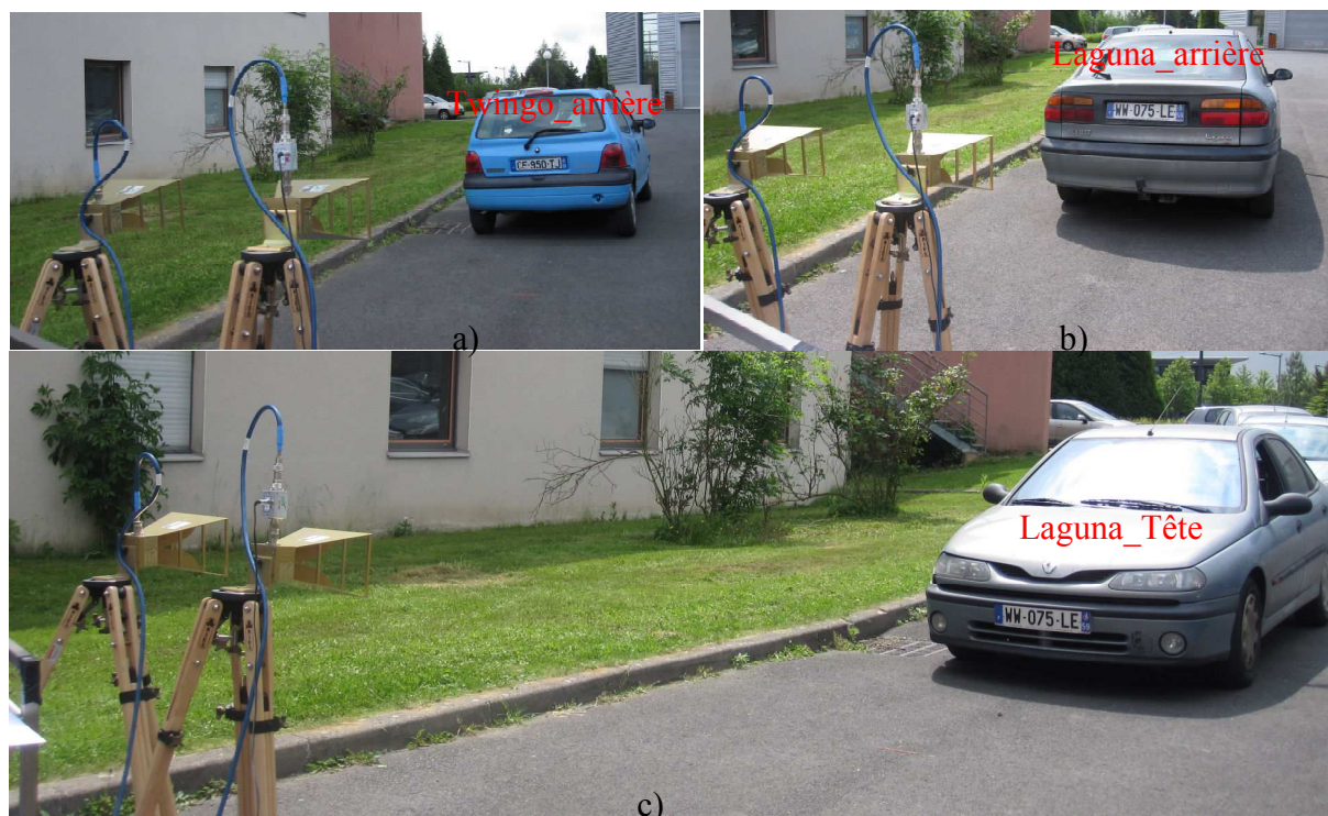
Figure 7-4 : Expérimentation d'enregistrement de signaux diffusés par les voitures : a) par l'arrière de la voiture Twingo; b) par l'arrière de la voiture Laguna; c) par la tête de la voiture Laguna
