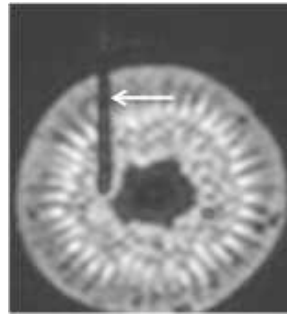
Figure 23: IRM d'un outil d'empreinte en PEEK dans un kiwi
