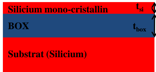
Figure I-40: Vue schématique en coupe d'un substrat SOI.
