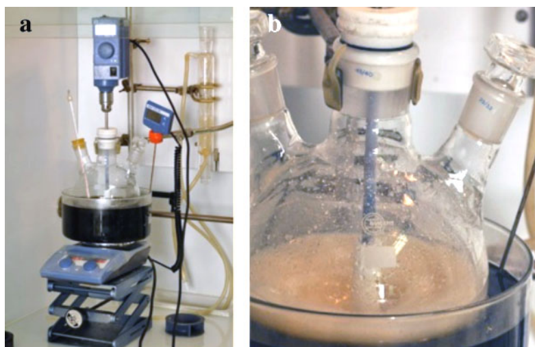
Figure II.1. a) Montage expérimental utilisé pour la préparation de NCC par hydrolyse acide de linters de coton. b) Aspect de la suspension après 20 min d'hydrolyse.
