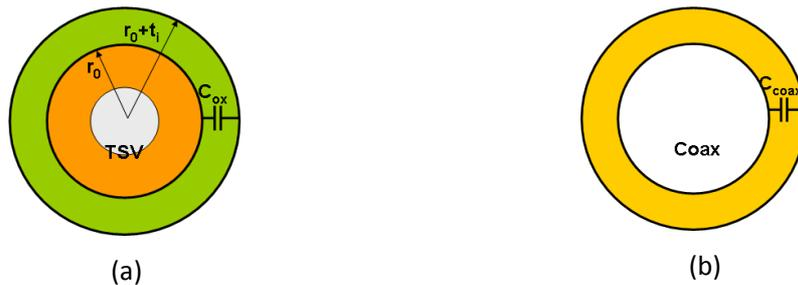
figure 4- 7 : Illustration de l'équivalence entre la capacité d'oxyde d'un TSV (a) et la capacité d'un câble coaxial (b)
