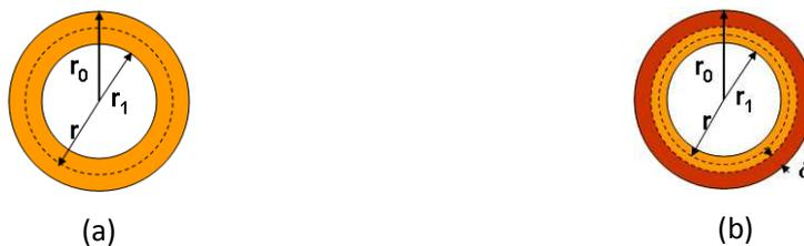
figure 3-3 : Représentation de la répartition du courant dans un conducteur creux : (a) TSV en statique ; (b) TSV avec effet de peau
