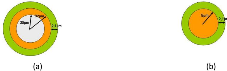
figure 4- 12 : Caractéristiques géométriques des TSV : (a) Moyenne densité, (b) Haute densité
