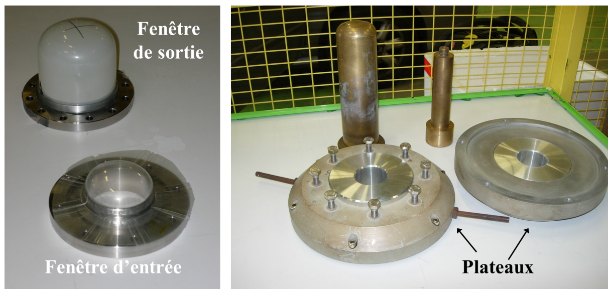
FIGURE 8.2 – (gauche) Photographie de la fenêtre d'entrée, posée sur une bride, et de sortie, collée à une bride, pour former une cible de 6 cm. (droite) Photographie des pistons servant à étirer les feuilles de Mylar préalablement disposées entre les deux plateaux et chauffées.
