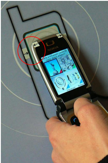
Figure n° 4 : le joueur rapproche son téléphone de la borne. Les flèches permettent de savoir où poser l'appareil. Photo PLUG, Aude Guyot
