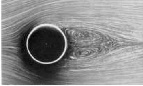
FIGURE 2.2 – Ecoulement autour d’un cylindre à  $Re = 26$ . Visualisations de S.Taneda extrait de VAN DYKE [3].
