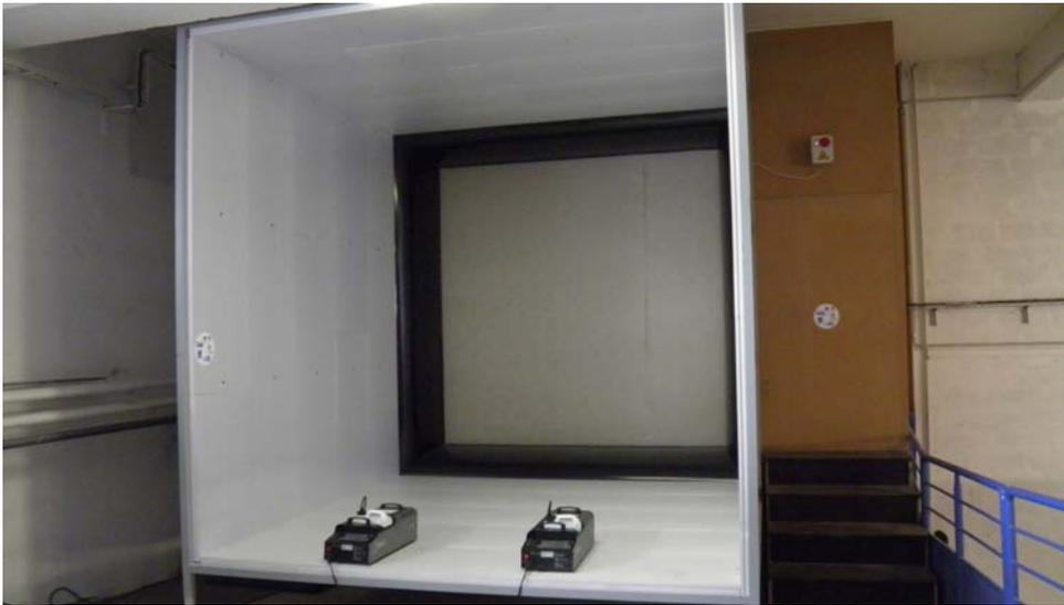
FIGURE 3.34 – Chambre d'injection ajoutée en entrée de soufflerie et systèmes d'injection de fumées associés
