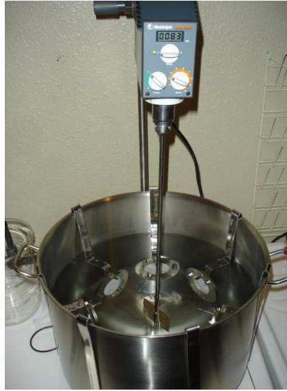
Figure 58. Dispositif expérimental de calibrage en laboratoire. Le couvercle a été retiré pour visualiser les POCIS et la pale dans l'incubateur.
