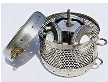
Figure 39. Dispositif d'exposition des POCIS in situ [EST-lab, 2012].
