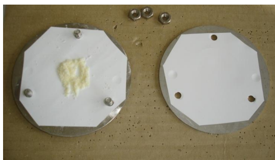
Figure 55. Photo d'un POCIS en construction, dépôt de 200 mg de phase adsorbante sur la membrane.
