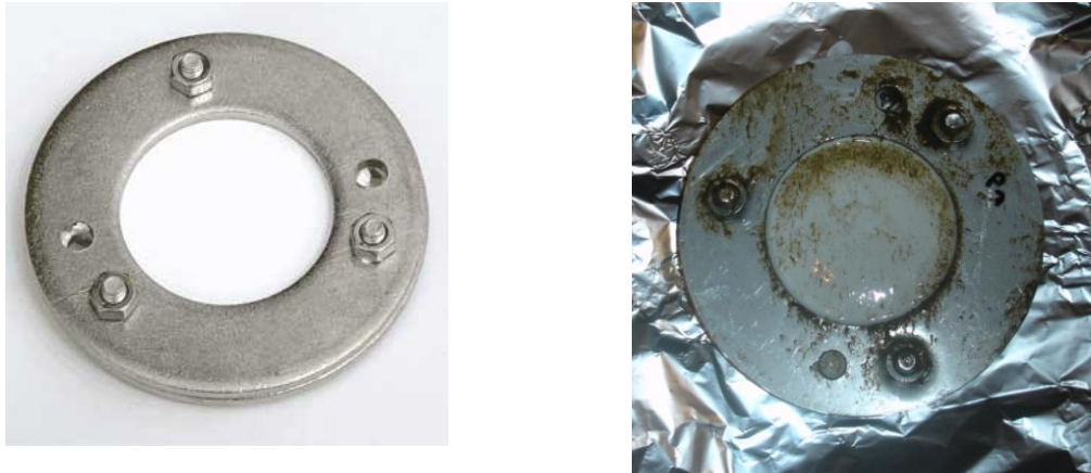
Figure 85. Aspect extérieur d'un POCIS avant et après 12 jours d'exposition dans de l'eau usée de l'hôpital. T = 25°C, vitesse de l'eau = 16 cm/s.
