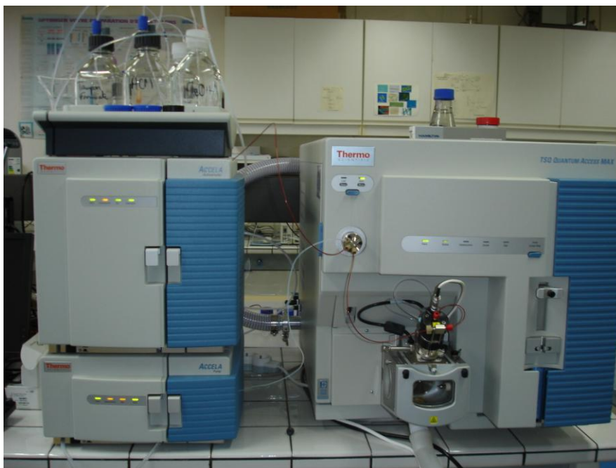
Figure 52. Couplage CLHP-SM/SM : pompe et passeur d'échantillons Accela couplés au spectromètre de masse TSQ Quantum Access Max, ThermoFisher Scientific.
