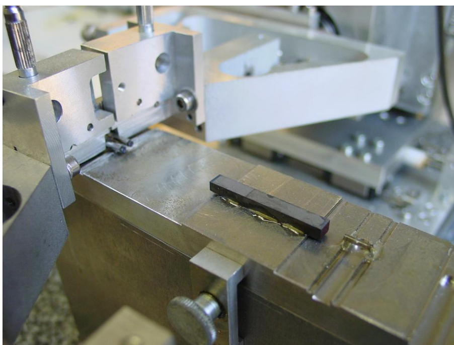
Photographie A.II.3: Mécanisme de positionnement des collimateurs signal d'un filtre BLU-AALO.
