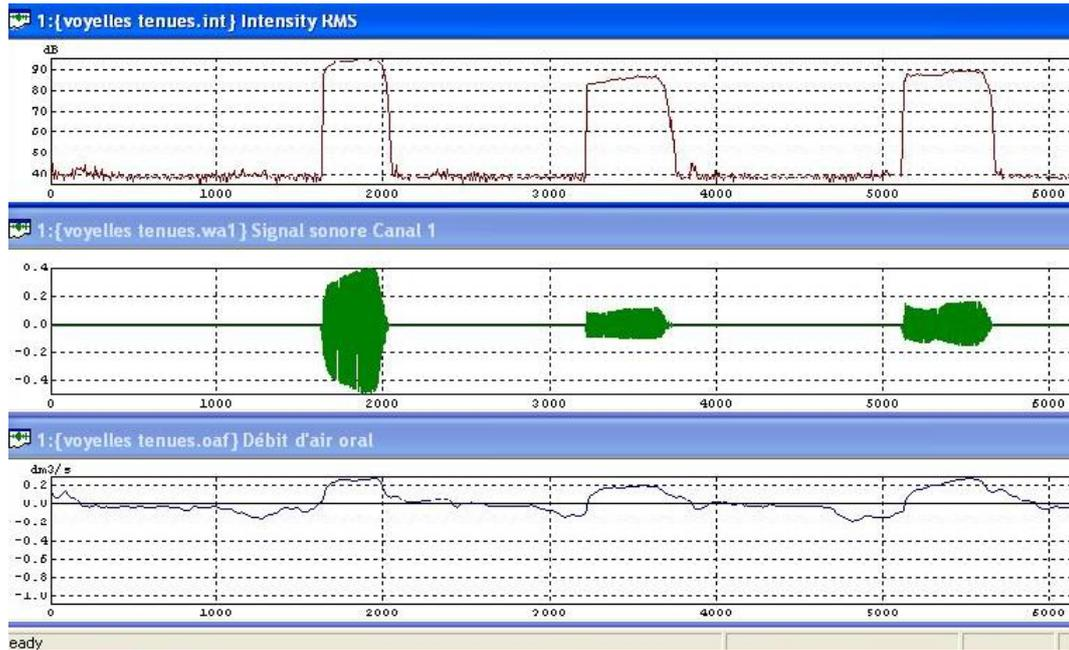
**Figure 6.3** – Courbes obtenues pour les voyelles tenues [a, i, u] sur Phonedit (exemple du témoin n°1). En haut, l'intensité sonore émise (dB) ; au milieu, l'oscillogramme ; en bas, le DAB en  $dm^3/s$ .
