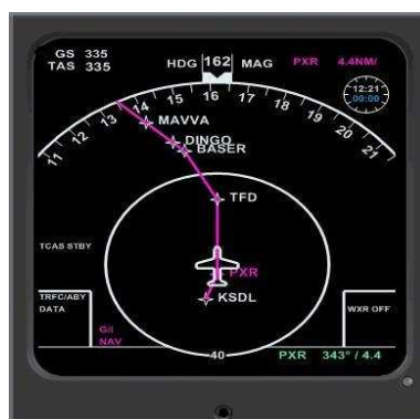
FIGURE 1 – Une partie d'un plan de vol affiché sur un écran de navigation
