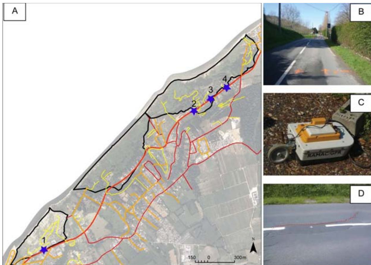
(A) Localisation des tronçons de route prospectés par GPR, (B) RD 513 au point de prospection au point 3, (C) Antenne RAMAC GPR utilisée, (D) Fissuration de la route au point 4.
