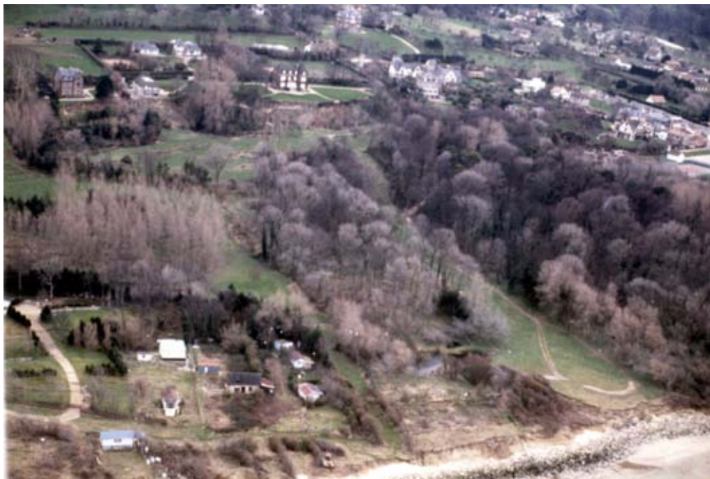
Figure 2-24. Vue aérienne des Fosses du Macre suite à l'accélération de février 1988 avec à l'arrière plan l'escarpement principal et au premier plan, de nombreuses fractures ouvertes (chemin à gauche).
