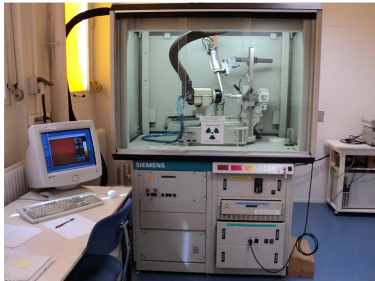
***Fig.(II-5) : Photo d'un diffractomètre de type Kappa CCD (Siemens).***
