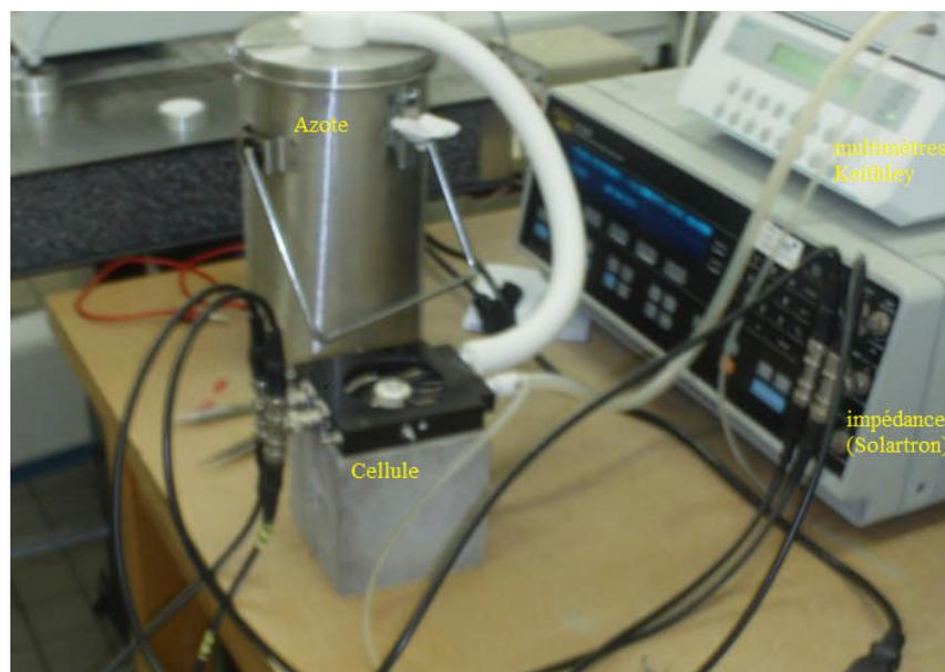
**Fig.(II-6) : Photo d'un montage d'analyse diélectrique.**
