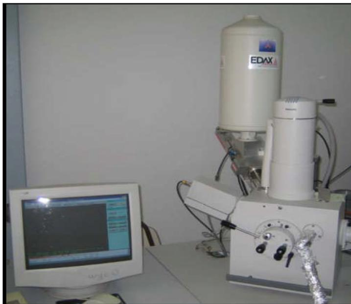
**Figure( II-1) Microscope électronique à balayage (MEB)**
