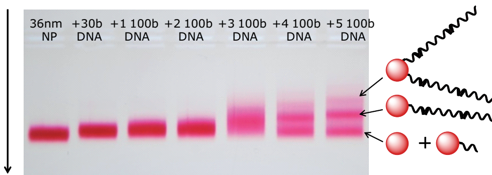
Figure 2.7 – Purification d'électrophorèse de NPsAu de 40 nm de diamètre liées à un brin d'ADN de 30 bases hybridé sur 15 bases avec un nombre d'oligonucléotides de 100 bases compris entre 1 et 5 (colonne 2 à colonne 7) comparé à une référence de particule seule (colonne 1).
