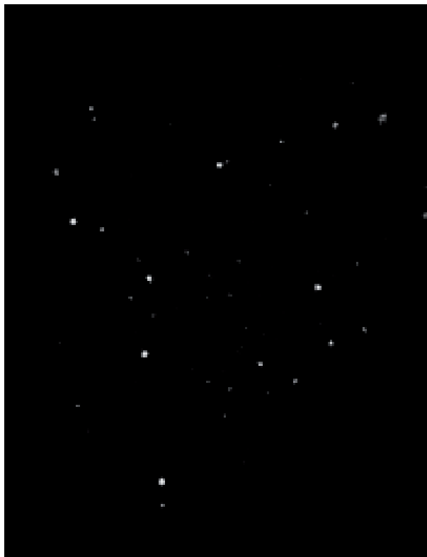
Figure 4.6 – Exemple d'image de fluorescence de dimères liés avec un double brin d'ADN de 50 paires de bases, alimentés au centre par une molécule d'ATTO647N unique, capturée par la caméra EMCCD (temps d'acquisition 100 ms, gain de 100, puissance incidente 30\mu\text{W} ).
