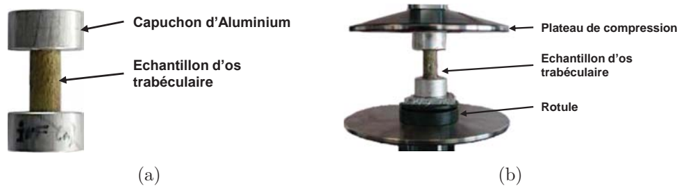
FIGURE 6.2: Montage des échantillons d'os trabéculaire pour la caractérisation mécanique par essai de compression : (a) échantillon d'os trabéculaire inclus entre deux capuchons d'aluminium ; (b) montage de l'échantillon entre les plateaux de compression du banc d'essai.
