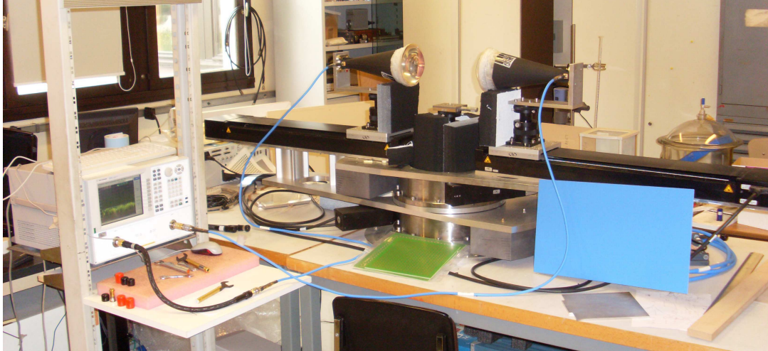
FIGURE 56 – Antennes focalisées et platines de déplacement micrométriques
