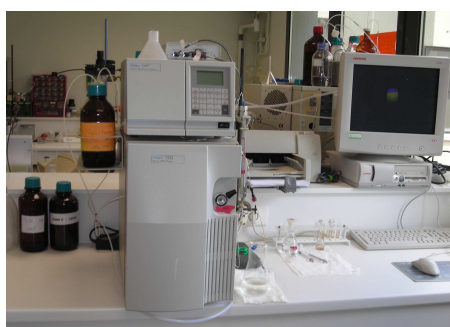
Fig. 18: HPLC utilisé pour purifier les produits détectés
