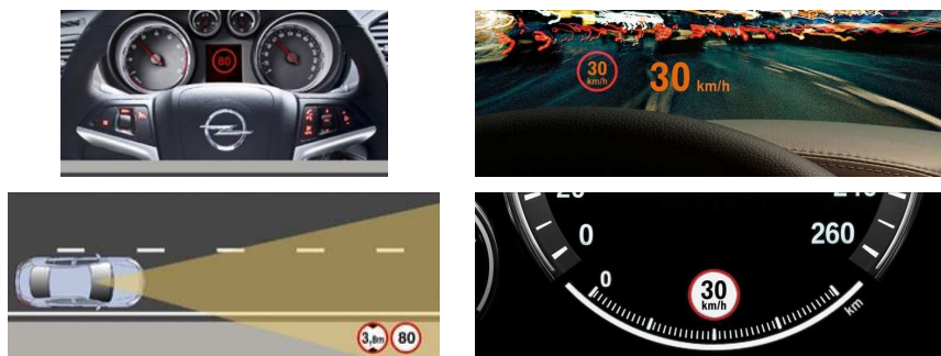
FIGURE 6.6 – ADAS indicateur de vitesse. A gauche sur l'opel insignia. A droite, sur la BMW série 7, en haut HUD, en bas affichage classique. Source http://www.opel-insignia.fr/ et http://www.bmw.fr/ .
