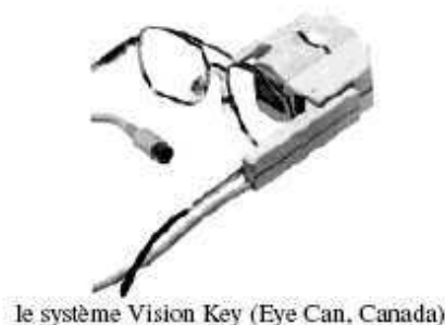
FIGURE 3.11 – Exemple d'oculomètre utilisant la technique du limbe. Source [101].
