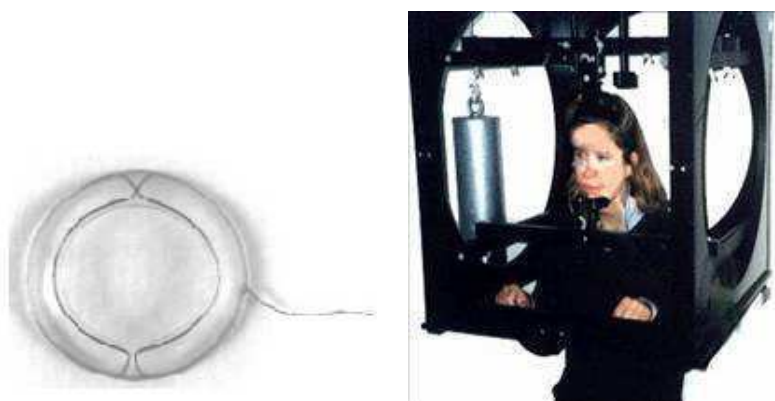
FIGURE 3.12 – Exemple d'oculomètre utilisant la technique de la galvanométrie. Source [93].
