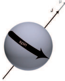
FIGURE 2.1 – Une charge en rotation induit un moment magnétique \mu lié à son moment cinétique J et aligné sur son axe de rotation (Kastler et al., 2006).
