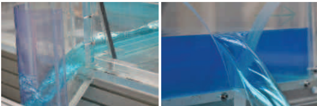
FIGURE 4.4 – A gauche : Chute libre en sortie de rue. A droite : photo d'un seuil à l'aval des canaux de mesure de débits.
