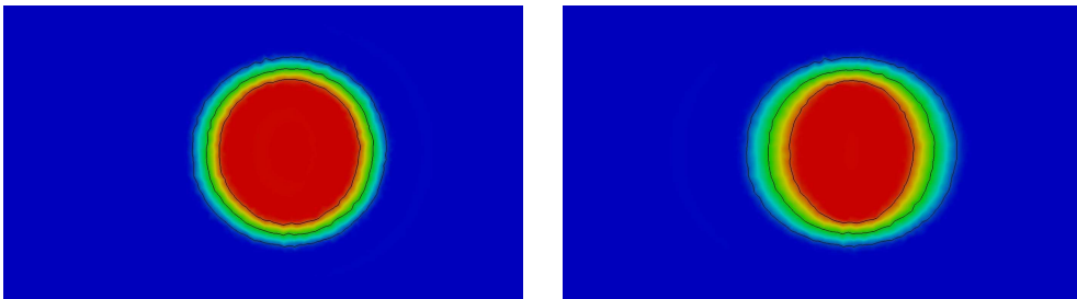
FIGURE 2.13 – Solution zoomée et courbes de niveau de 0.1, 0.5, 0.9 pour k = 1 avec une CFL de 0.5 (gauche) et 10 (droite)
