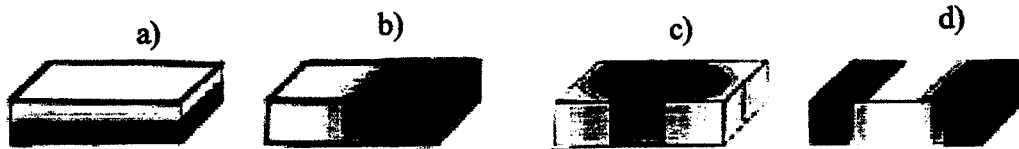
Figura 1.16 Rappresentazione schematica della variazione di struttura di un FGM a) in direzione longitudinale b) in direzione trasversale c) concentricamente d) dal centro verso le superfici esterne 4
