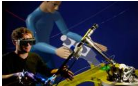
Figure 1 – Exemple de tâche de prototypage virtuel avec retour d'effort
