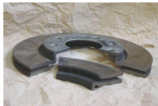
Fig. I.15 : Exemple de disque ventilé.
