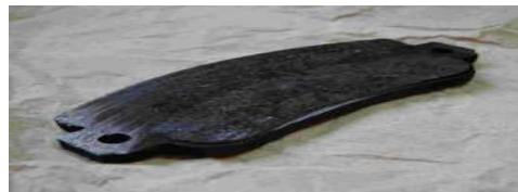
Fig. I.33 : Usure excessive des plaquettes
