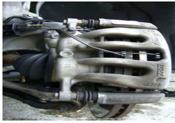
-a- : Etrier flottant de la C6.
