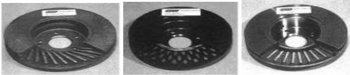
Fig. I.16 : Différentes géométries d'ailettes.
