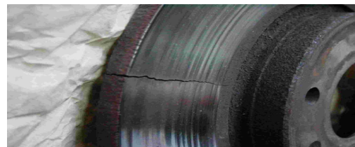
Fig. I.25 : Fissure radiale sur les pistes de frottement
