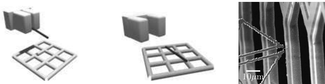
F . IV.38 – Saisie et dépôt d'un nanotube sur une grille TEM
