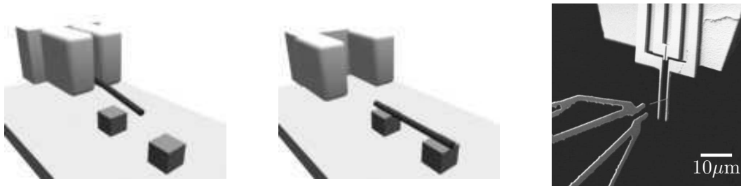
F . IV.39 – Saisie et dépose d'un nanotube entre deux électrodes
