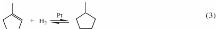
Figure I-8 : (1) Déshydrogénation sur métal, (2) contraction du cycle sur support et (3) hydrogénation sur métal dans le cas des catalyseurs bifonctionnels.
